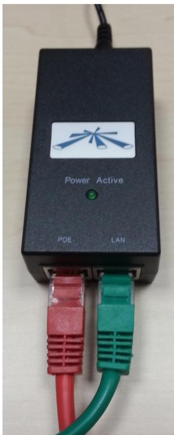
1. Utilizzando uno dei cavi rete in dotazione, collegare un estremo in una qualsiasi porta "Ethernet" – "LAN" (di colore arancione) del gateway WiSpot e l'altro estremo del cavo nella porta "LAN" dell'alimentatore (nell'immagine cavo di colore verde).
